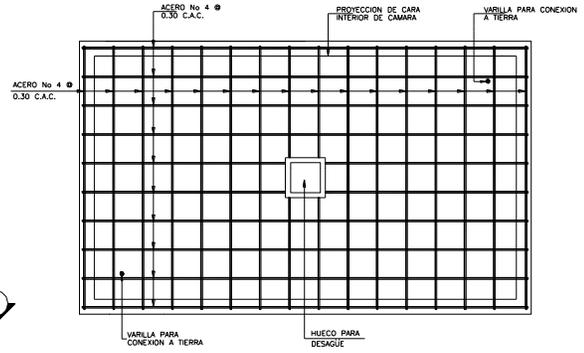
ESTRUCTURA DE LOSA INFERIOR
