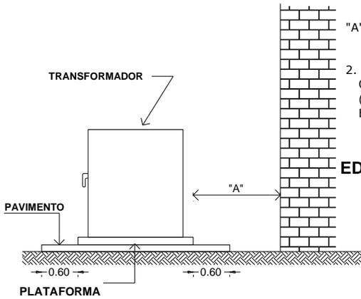
1. "A" MINIMO 0.61M (2') PARA TRANSFORMADOR DE 500\_KVA
