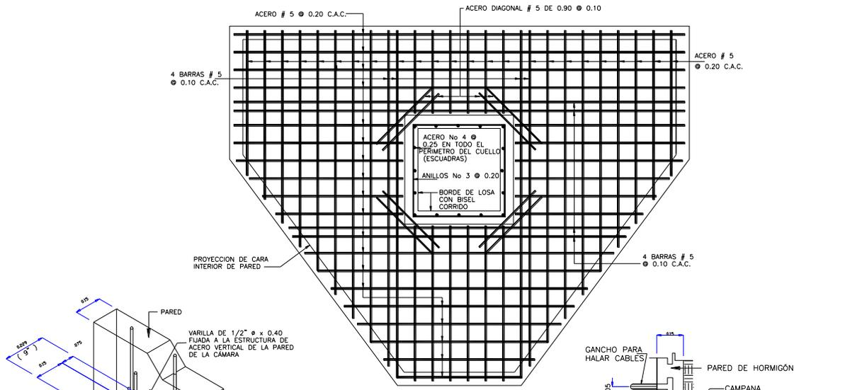
ESTRUCTURA DE LOSA SUPERIOR
