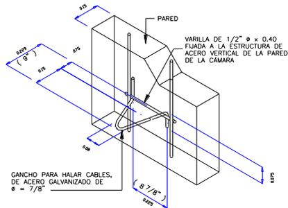
DETALLE DE EMPOTRAMIENTO DE GANCHO EN PARED DE CÁMARA
