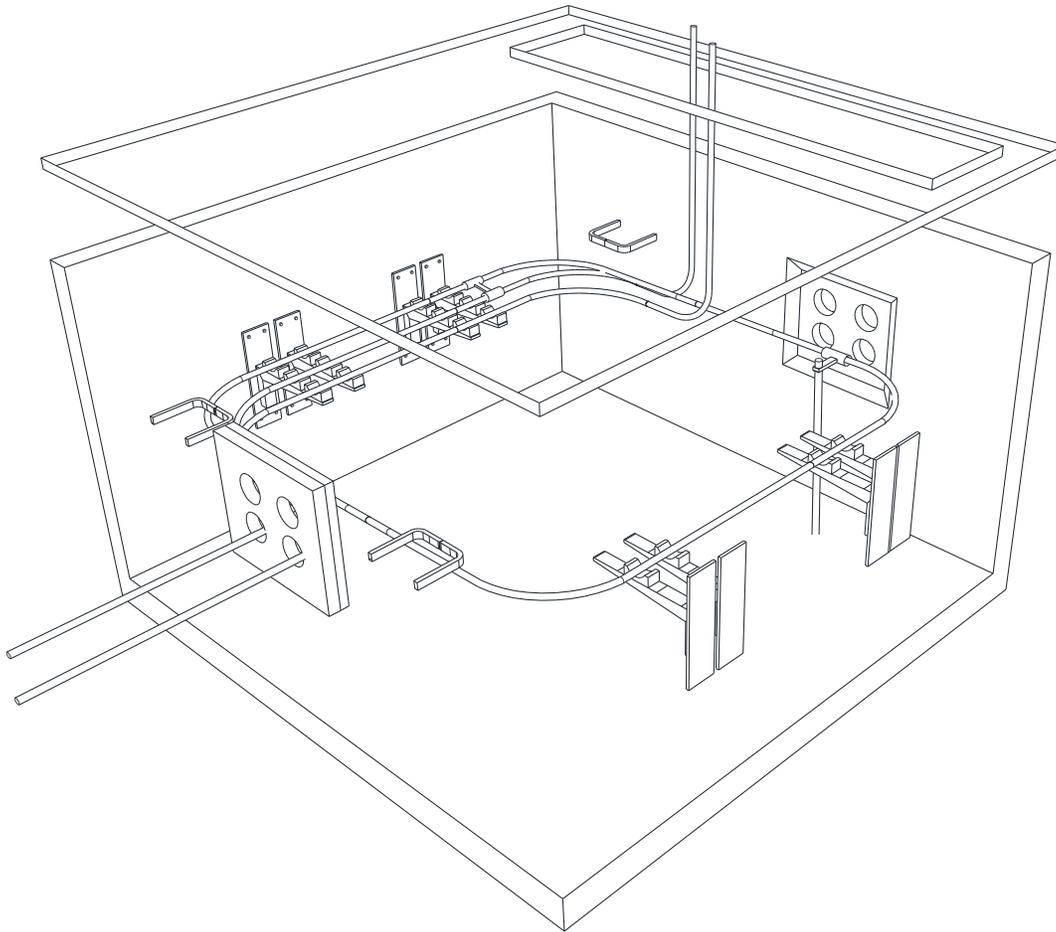
**DISPOSICIÓN DE ACCESORIOS EN CÁMARA DE PASO PARA TRANSFORMADOR TIPO GABINETE TRIFÁSICO**
