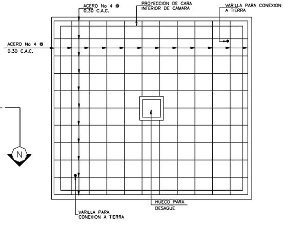
ESTRUCTURA DE LOSA INFERIOR
