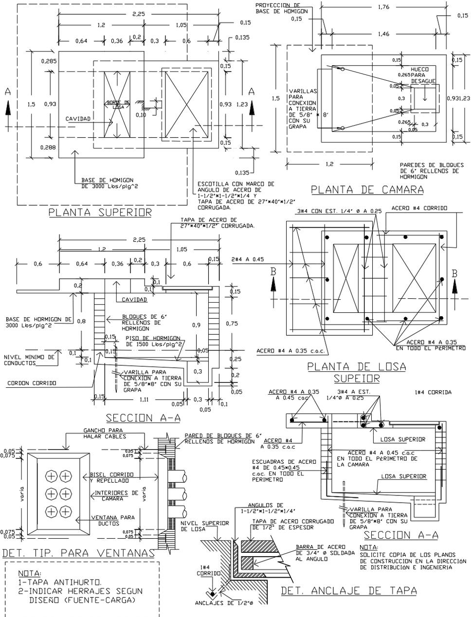
**BASE DE HORMIGÓN Y CÁMARA DE PASO PARA TRANSFORMADORES MONOFÁSICOS TIPO GABINETE UC 80-23-144**
