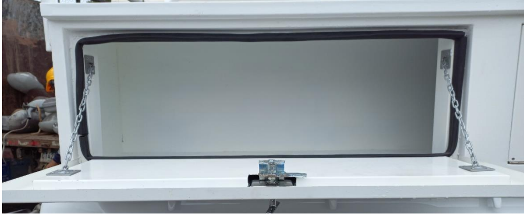
Fig. 3 Configuración de la gaveta, con fijación tipo cadena.
