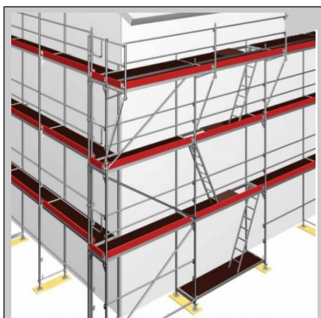
Andamio de fachada
