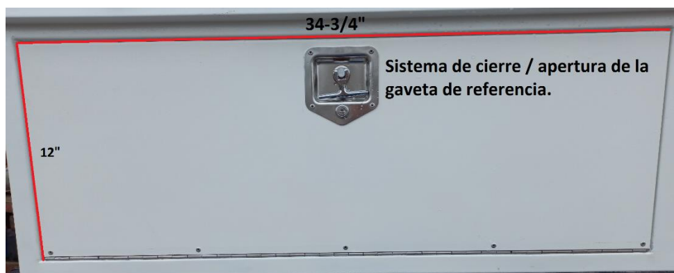
Fig. 1 Medidas internas que puede tener las gavetas del equipo.
