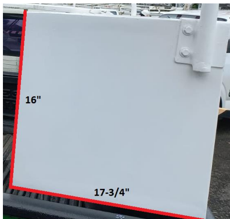
Fig. 2 Medidas externas que pueden tener las gavetas del equipo.
