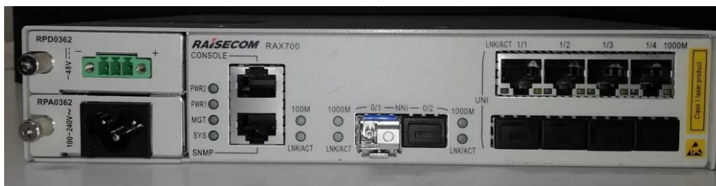
Imagen 4.1: Ejemplo de equipo CPE industrial con doble fuente (48VDC y 120VAC).
