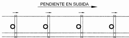
EN PENDIENTES: TODAS LAS CRUCETAS SE COLOCAN HACIA EL PUNTO MÁS ALTO DE LA PENDIENTE
