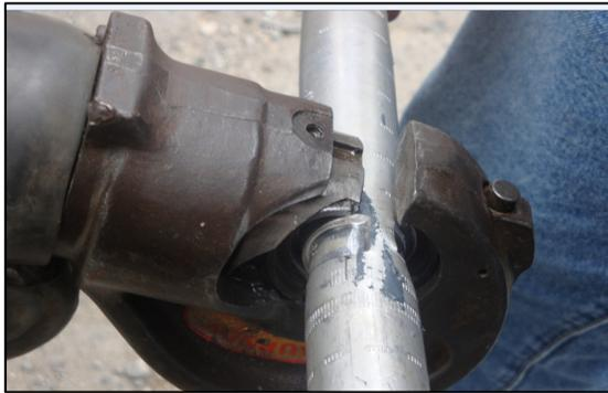
Figura N°5. Compresión Conector.
