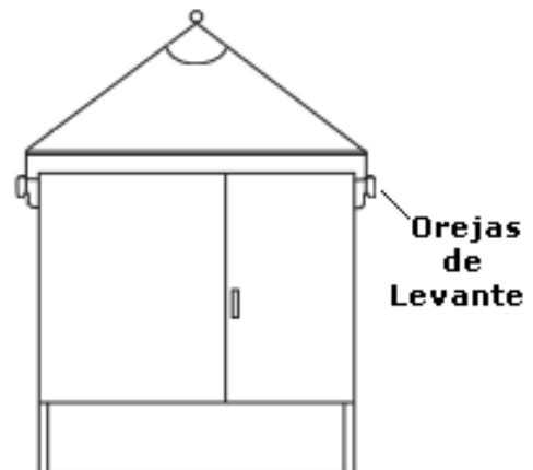
Figura N° 7. Transformador de gabinete izado con grúa, a través de todas sus orejas de levante. La cantidad de orejas varía de acuerdo al peso del transformador y usualmente son 2 o 4.
